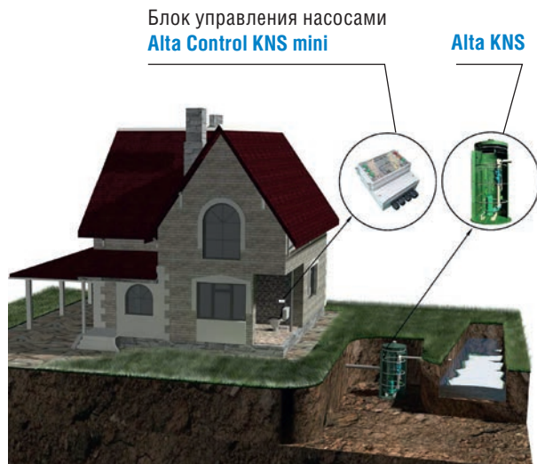
Пример размещения блока управления насосами
