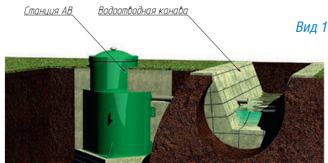
Рисунок 5. Пример реализации простого самотечного выпуска очищенной воды в водоотводную канаву
